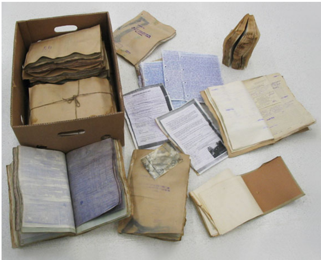
ILLUSTRATSIOON 1. Tintide ja pigmentide migratsioon, köidete paisumine ning deformeerumine
