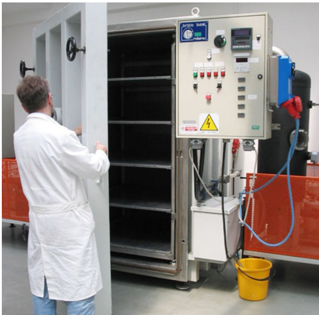
ILLUSTRATSIOON 10. Vaakumkülmutusseade (kasutusel Tšehhi Rahvusarhiivis)
