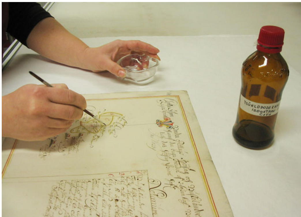
ILLUSTRATSIOON 13. Pigmentide kinnitamine tsüklododekaaniga
