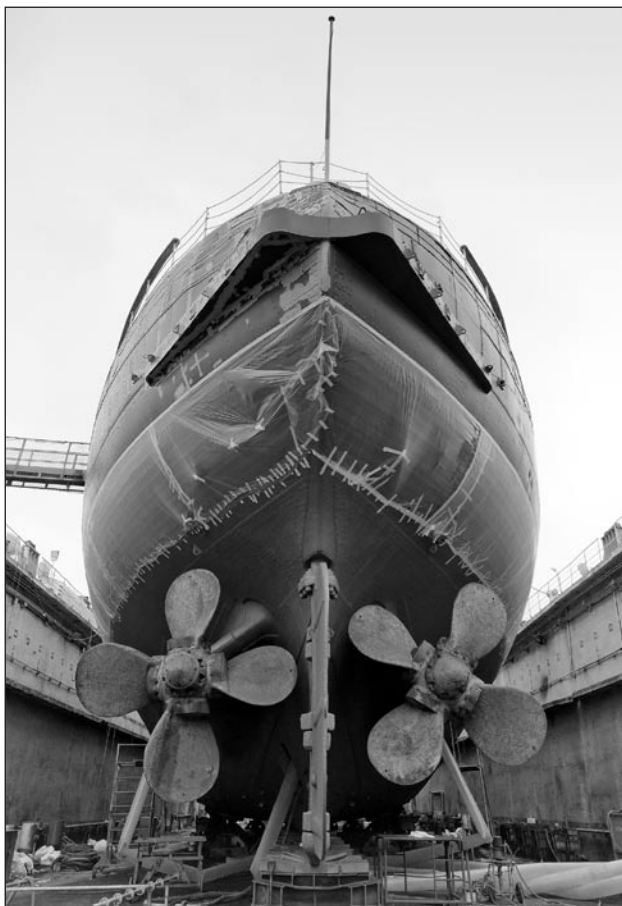
Jäämurdja Suur Tööl dokis Paljassaare sadamas, oktoober 2013. Kere korrastamisele ja värvimisele lisaks teostati dokis tankide puhastus ning kerepladistuse paksuse mõõtmine. Foto: V. Lõhmus, EMM TA kogu
