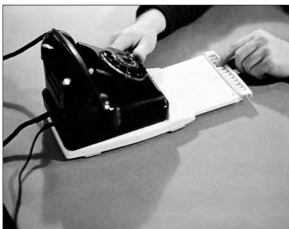
▲ Telefon ja tehases „Salvo“ välja töötatud miniatuurse klahvistikuga varustatud telefonialus koos sellesse paigutatud abonentide nimekirjaga 1966. aastal. Foto: Ilmar Prooso. EFA 0-52776
