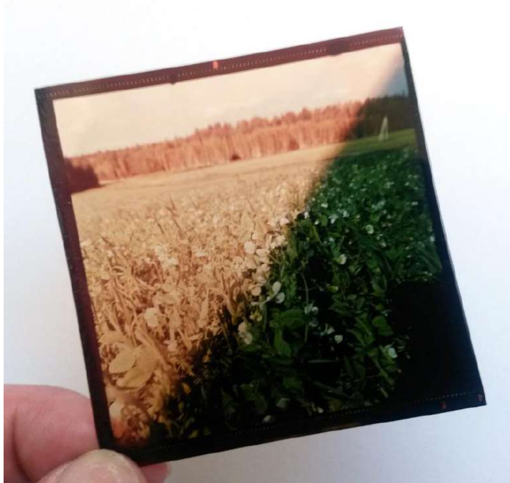
Testfoto (kromogeen-diapositiiv) on osaliselt musta papiga kinni kaetuna eksponeeritud aknal, loomuliku valguse käes, kahe kuu jooksul. Tulemuseks pleekimine, mis põhjustab kollakat tonaalsust. Erakogu, Kadi Sikka
