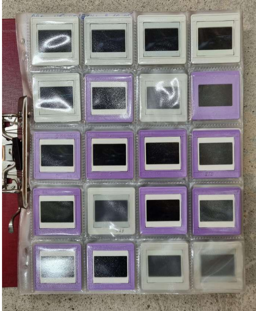
Ebasobivasse PVC kilesse pakendatud slaidid. Kile lokib ja on kleepunud slaidide külge. Foto: Kadi Sikka
